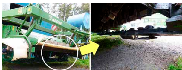
写真2 ハイスキットの設置によるフロートイング（高さ）の調整
