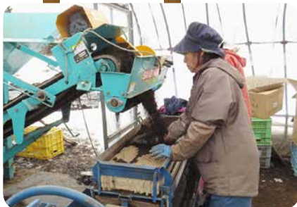
広げたペーパーポットに土を入れていきます
