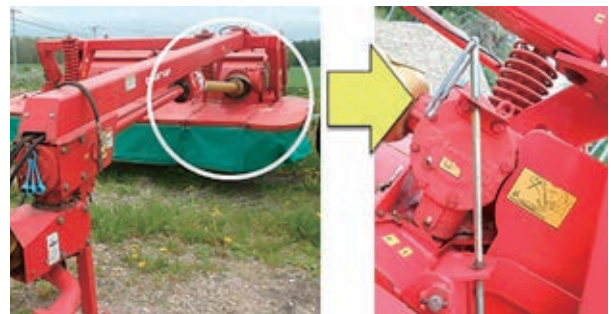
写真1 カッターバーの高さ調整(角度調整)をおこなうハンドル部分(メーカーにより異なります)
