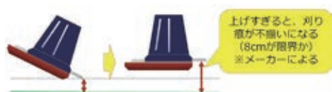
図2 モアコンのカッターバーによる高さ調整
