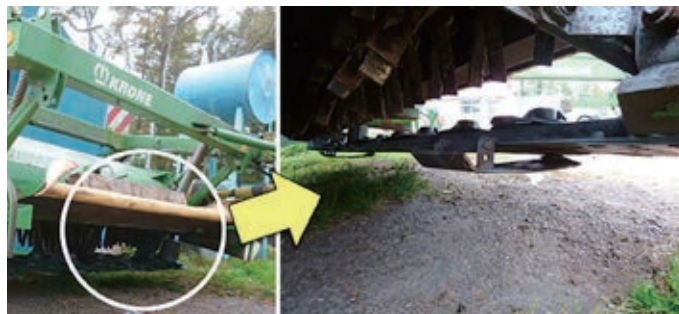
写真2 ハイスキットの設置によるフロートイング(高さ)の調整
