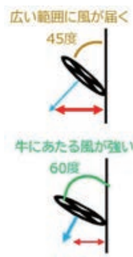
図3 送風機の設置角度による違い
